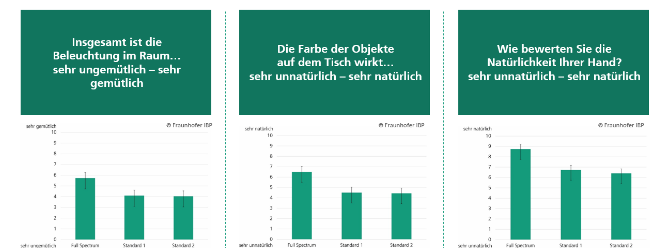
Abbildung 2: Ergebnisse der subjektiven Bewertung des visuellen Komforts auf verschiedenen Skalen für die Vollspektrum-LEDs im Vergleich zu zwei Standard-LEDs
