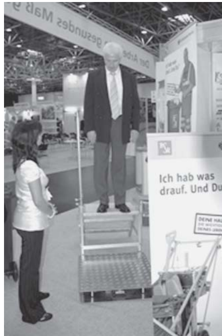
„Wie hart kommt Man(n) beim simulierten Absprung vom Müllwagen auf?“ Dr. Schurig, DGUV, am Messgerät der Berliner Stadtreinigung
